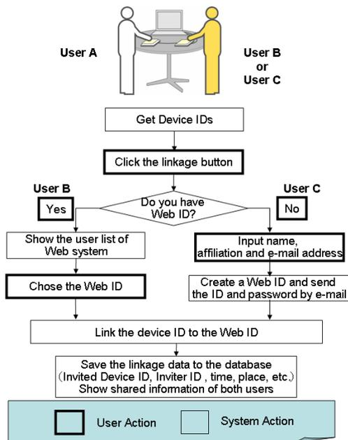
図 1 デバイスリンク原理
